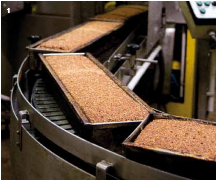
1 Ofenfrisch: Vom Netzbandofen laufen die Brote nach dem Backen in Richtung Entkapsler, der sie aus den Formen holt. 2 Verpackt: Die Brote sind fast fertig für den Verkauf. Es fehlt das Brot-Etikett.
