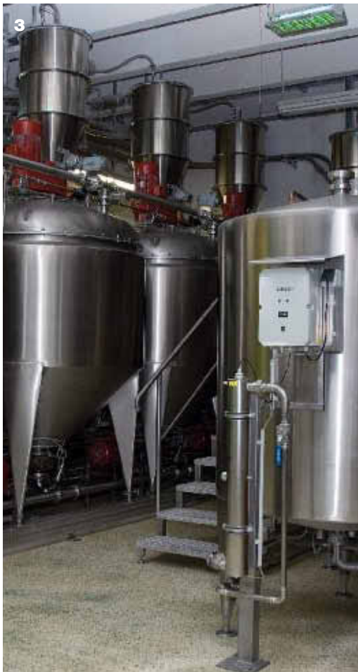
1 Knackig: Aus ganzen Roggenkörnern wird Roggenvollkornschrot. 2 Kontrolle: Qualitätssicherung ist Pflicht. 3 Vollautomatisch: die Sauerteig- und Brühstückanlage.
